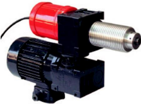
De Tambor .. Incluye motor de 0,50 HP y doble reductor de 1:300 final.
